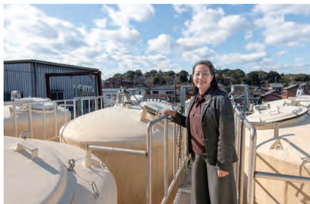
屋上に設置されたミエマン醤油の醸造タンク。半年以上かけてもろみを発酵させ、压榨工程へと移っていく。
