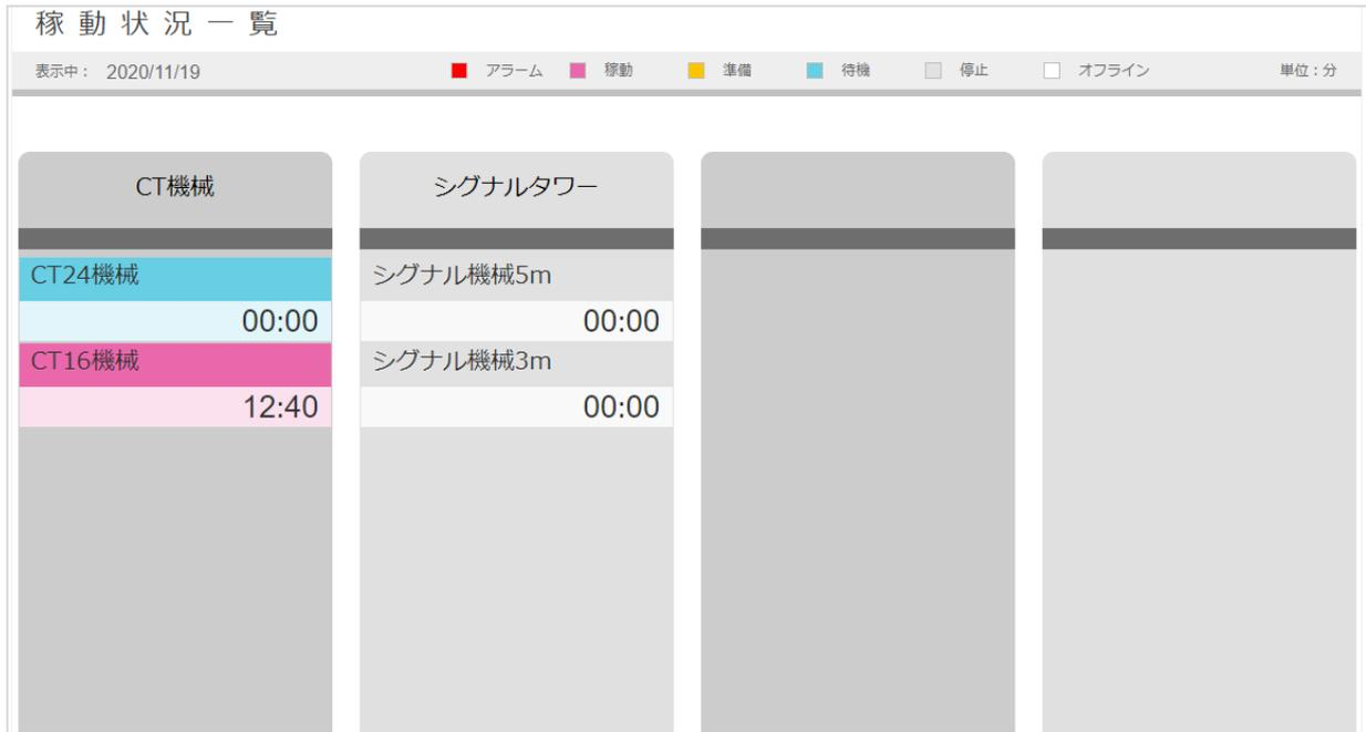
現在の各機械の稼動状況及び、本日の累積稼動時間を表示します。
